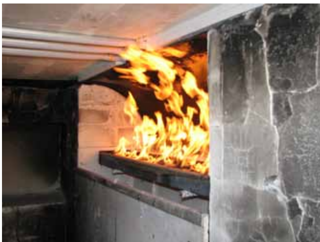
7. ÁBRA: VILÁGÍTÓTEST GYÚJTÁSVESZÉLYESSÉG-VIZSGÁLATA
