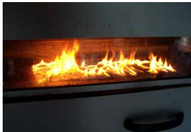
9. ÁBRA: PADLÓBURKOLAT VIZSGÁLATA (LÁNGTERJEDÉS) SUGÁRZÓ HŐ HATÁSÁRA AZ MSZ EN ISO 9239-1 SZERINT
