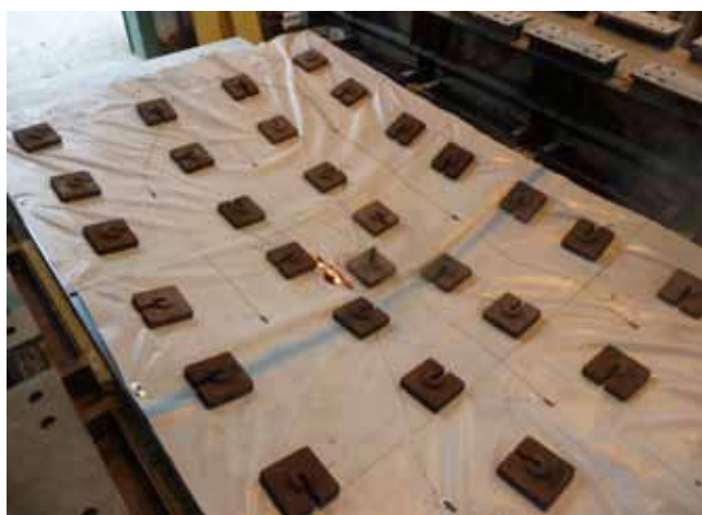
4. ÁBRA: TETŐFÜDÉM TÉRELHATÁROLÓ SZERKEZET TŰZÁLLÓSÁGI VIZSGÁLATA. A SZERKEZETEN JELENTŐS LEHAJLÁS MELLETT LÁNGÁTTÖRÉS IS MEGFIGYELHETŐ
