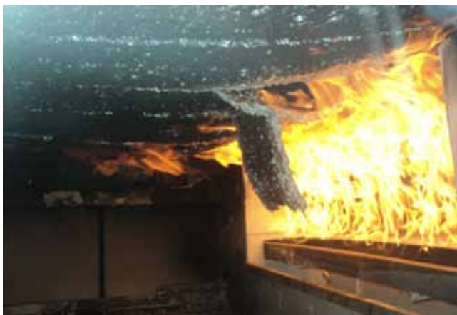
8. ÁBRA: FEJ FELETT ALKALMAZOTT BURKOLAT GYÚJTÁSVESZÉLYESSÉG-VIZSGÁLATA
