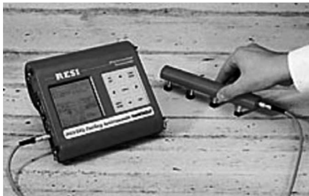
7. ábra. Elektromos ellenállás mérése betonon (Simon, Vass, 2011)
