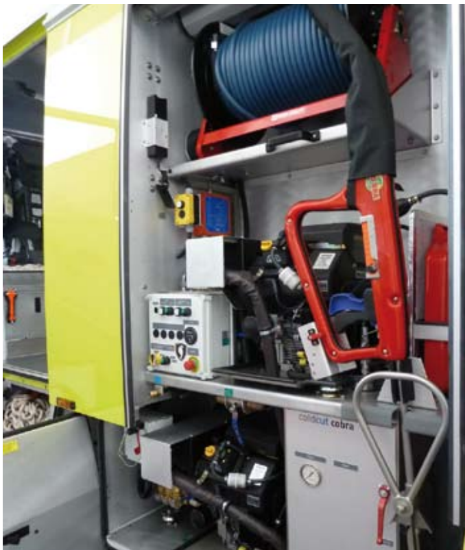
ColdcutCobra rendszer beépítve a járműbe
