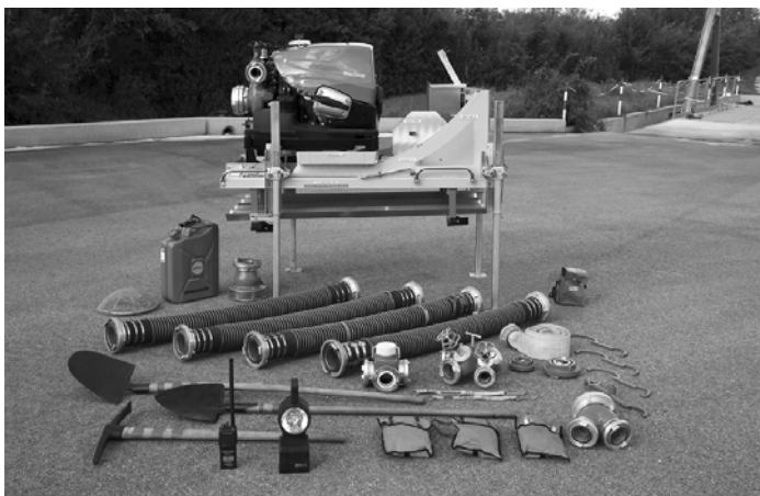
Szivattyú egység a teljes szívóoldali felszereléssel
