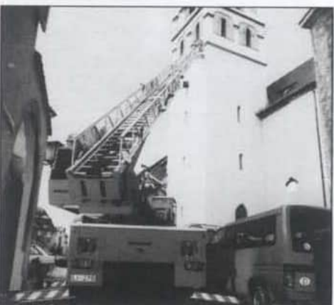
A fokozatmentes kitémasztással szűk terekben is működőképes a Vario CC.
