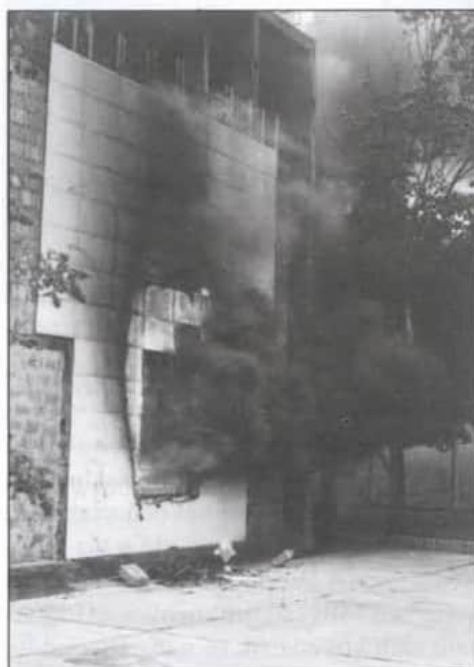
Az ablakok közötti burkolólap lehullik (23. perc)
