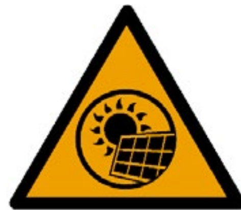
napelemes (PV) rendszer veszélye
