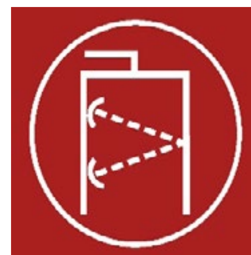
beépített porral oltó tűzoltó berendezés kézi vezérlése
