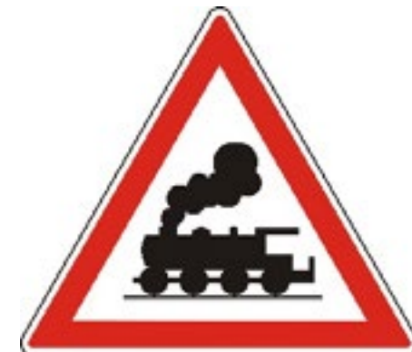
sorompó nélküli vasúti átjáró
