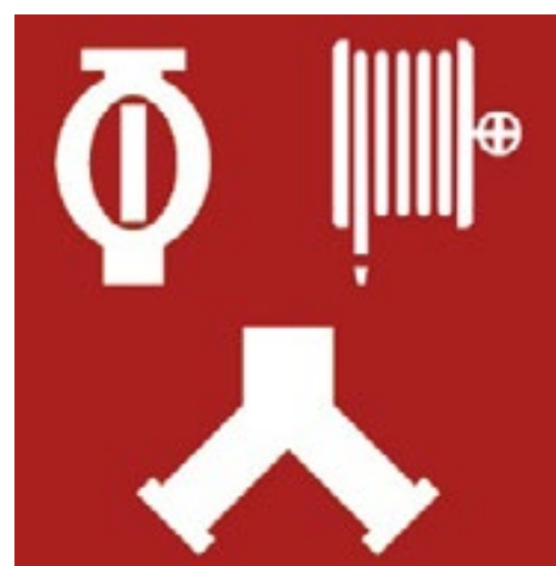
sprinkler oltórendszer és fali tűzcsap megtáplá- lási pont
