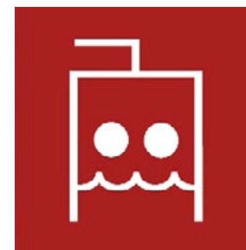
beépített habbal oltó tűzoltó berendezés
