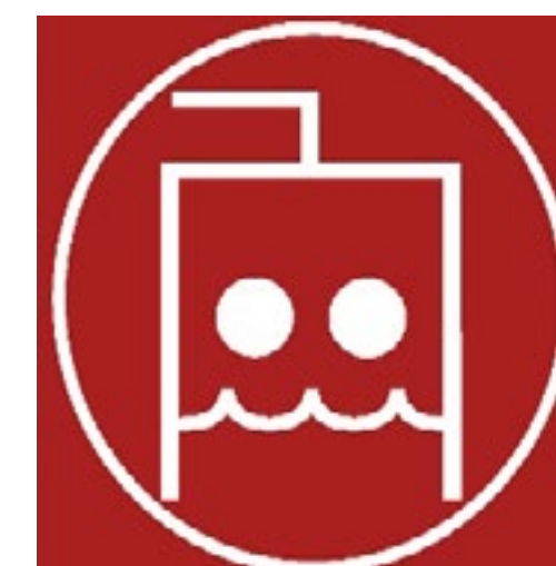
beépített habbal oltó tűzoltó berendezés kézi vezérlése
