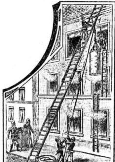
10. ábra: A mentőzsák megtelepítve leeresztésre készen. Baloldalt háttérben pedig, már hozzák a mentőkosarat. 9
