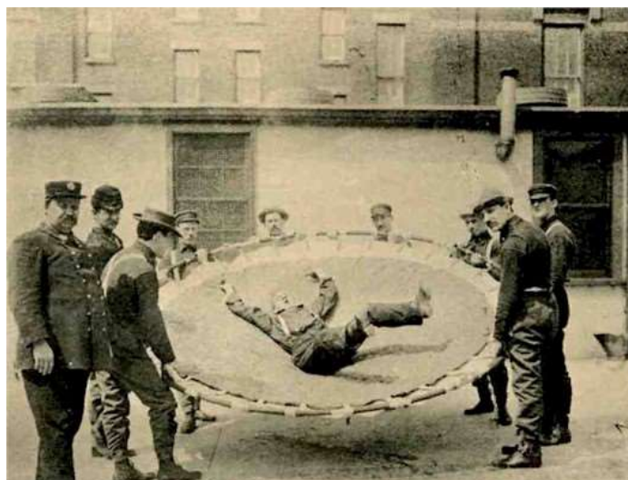
19. ábra: Az amerikai "Browder Life-Savings Net" körben abroncs merevítéssel, ami zsanéros kivitele miatt félbehajtható, az 1900-as évek elején. 17
