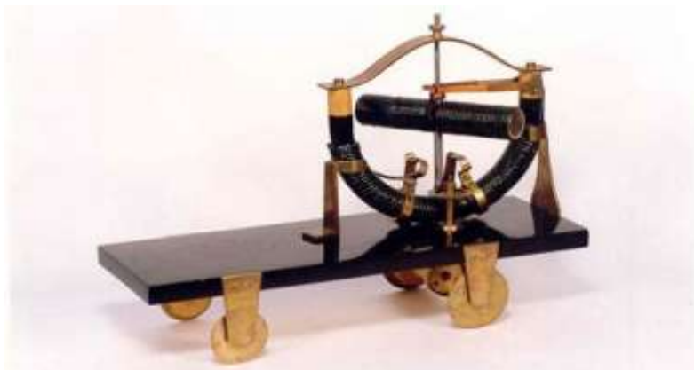
1. számú ábra: Jedlik Ányos – az első elektromos motor, modellautóra szerelve Forrás: http://www.jarmunaplo.hu/jedlik-anyos-erintoleg/ letöltés: 2019.04.26. 14:30
