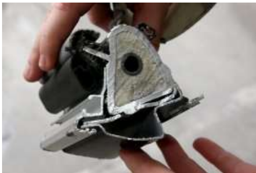
24. számú ábra: Milwaukee fűrész a feszítővágóknál alkalmasabb a könnyűfém karosszériákhoz Forrás: http://www.autonavigator.hu/sztori/hogyan_mentik_a_serulteket_a_tuzoltok-4035# - letöltés: 2018.03.16. 08:35
