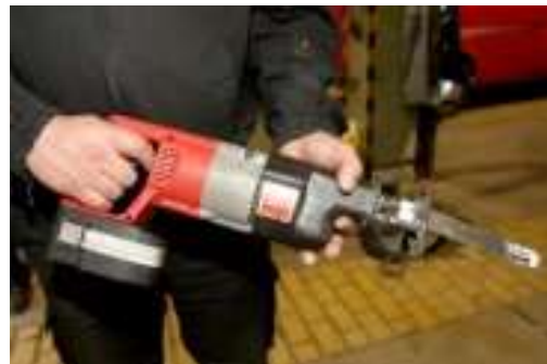
24. számú ábra: Milwaukee fűrész a feszítővágóknál alkalmasabb a könnyűfém karosszériákhoz Forrás: http://www.autonavigator.hu/sztori/hogyan_mentik_a_serulteket_a_tuzoltok-4035# - letöltés: 2018.03.16. 08:35
