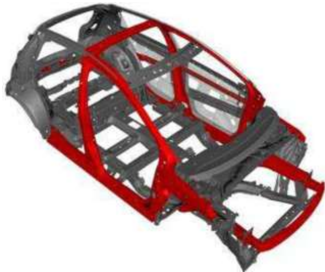
17. számú ábra: a jármű vázszerkezete – könnyebben és nehezebben vágható területek forrás: Renault Zoe - First responder guide - letöltés: 2019.02.07. 09:22
