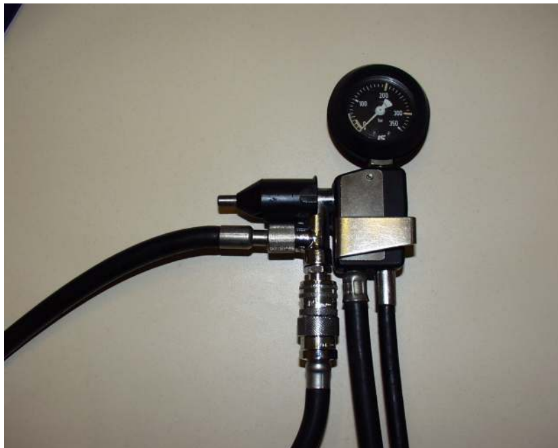
18.ábra Középnyomású tömlőcsatlakozás a gyorscsatlakozón keresztül
