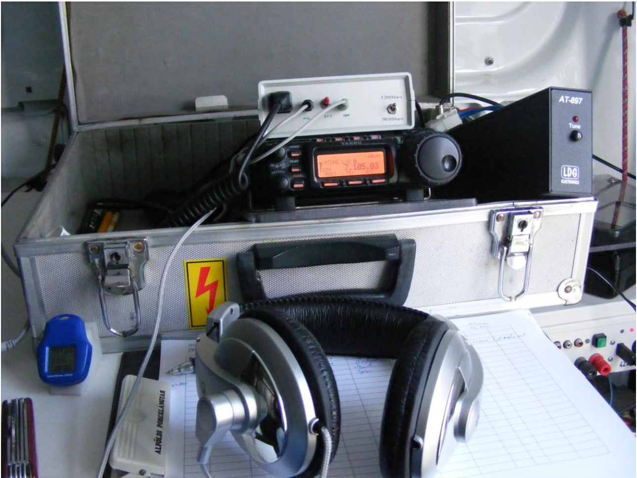
Hordozható RH állomás, gépjármű akkumulátoráról üzemeltetve
