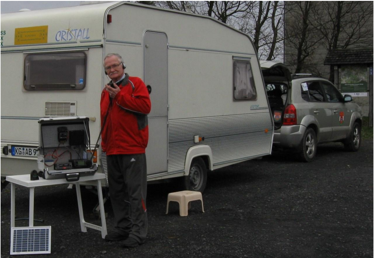
Lakókocsi akkumulátorról működtetett rádióállomás, napelem rásegítéssel.
