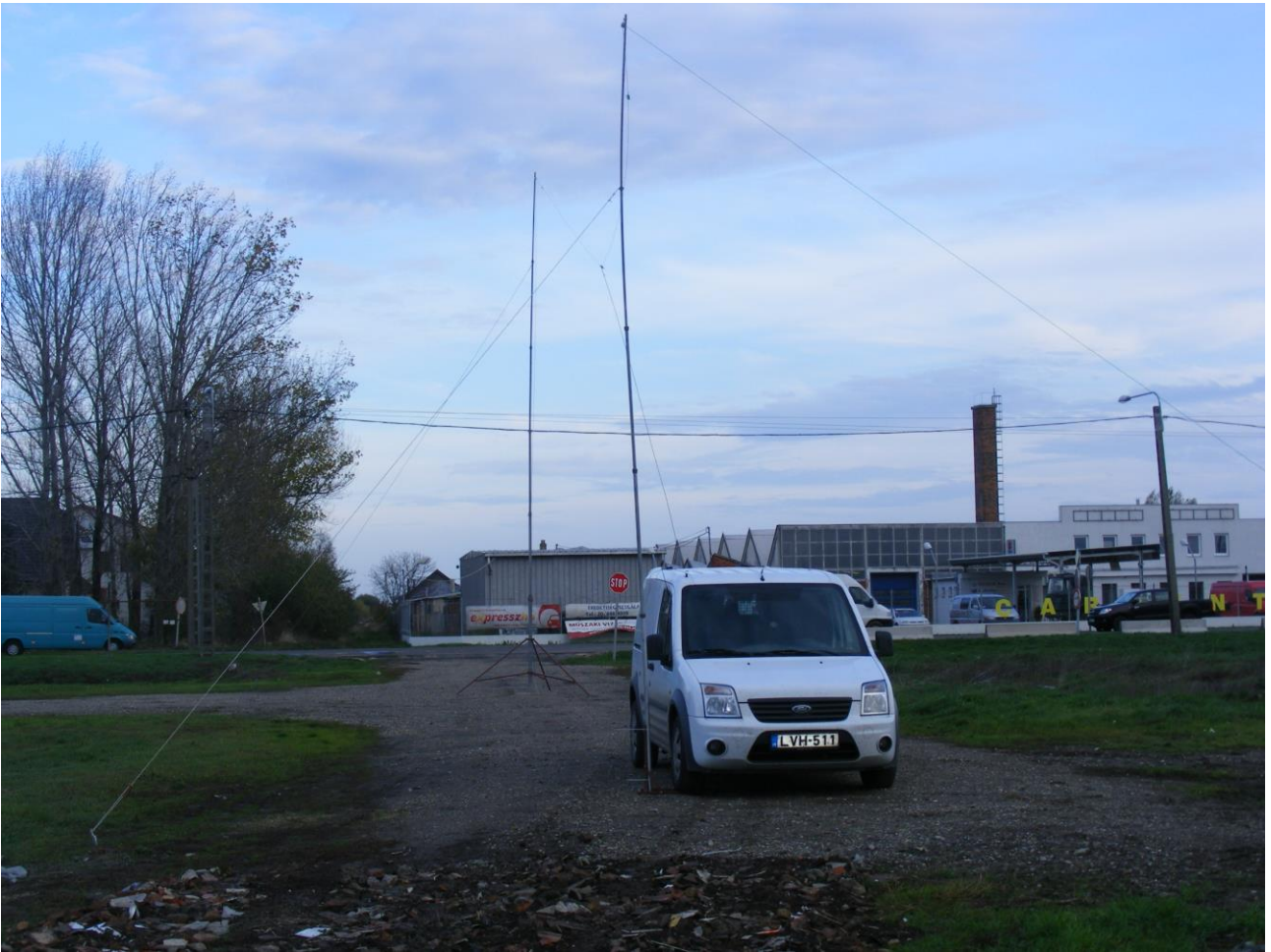
7 MHz-es dipól-antenna, két gyorsan telepíthető árbocközött kifesztve.
