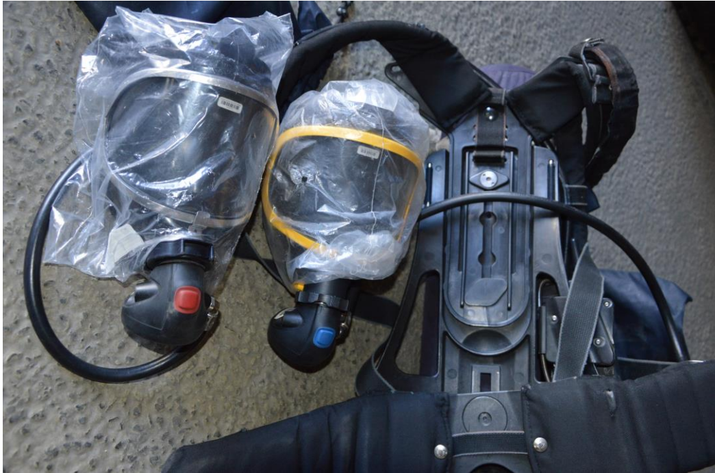
3. kép Dräger PSS 100-hoz csatlakoztatott normal és túlnyomásos tüdőautomata. (Forrás: Saját. Lészült: 2014.05.10.)
