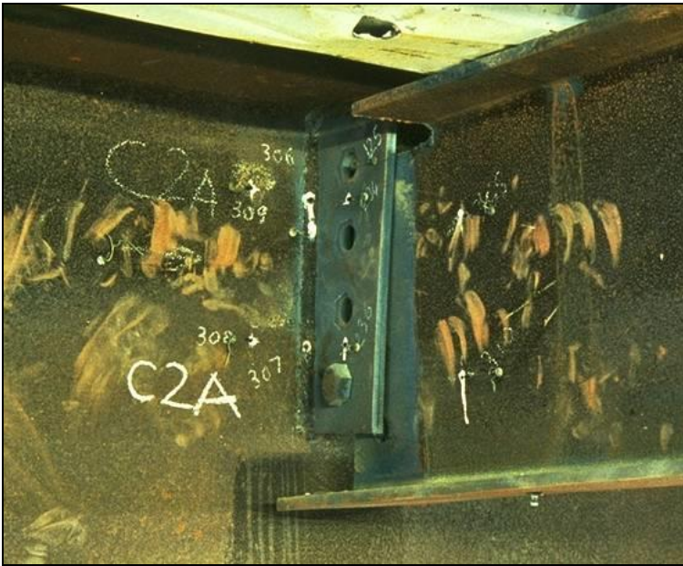
8. ábra Gerincbekötő lemez a tesztet követően
