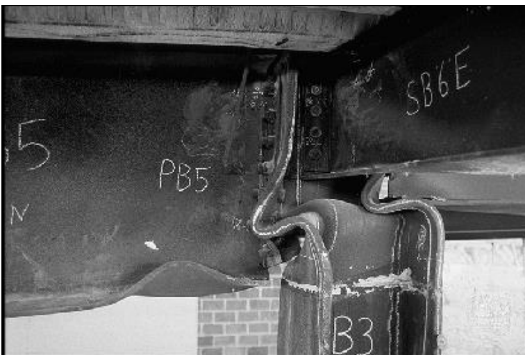
7. ábra Összenyomódott oszlopfej a tesztet követően
