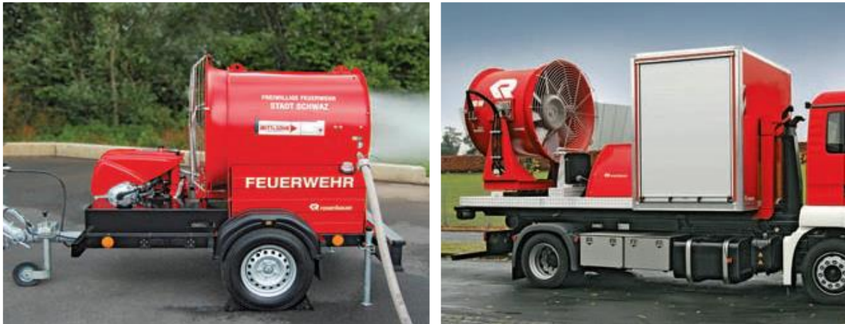
1. sz. kép: Utánfutóra, cserefelépítményre szerelt ventilátorok (Forrás: Rosenbauer gyári ismertető, Leonding 2011)
