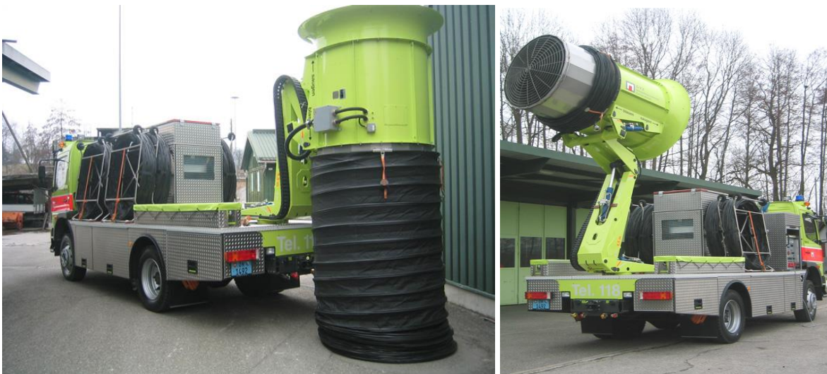
2. sz. kép: Több síkban használható nagyteljesítményű ventilátor (Forrás: Schutz und Rettung Zürich)
