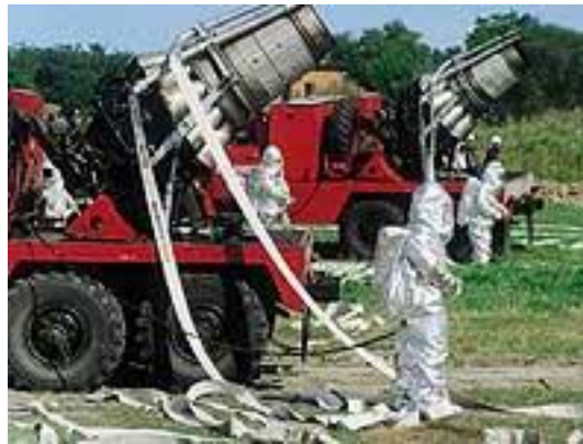
2. sz. kép: A Zil-131 alvázra épített turboreaktív oltógépek (Forrás: Győr MJV Hivatásos Tűzoltósága archivuma 2009)
