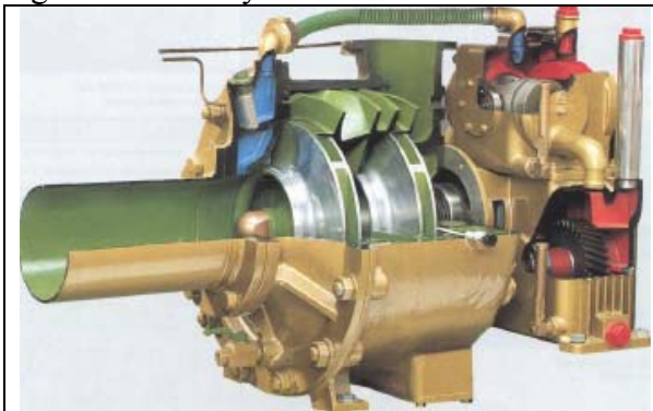
hengeres nyomótérű (soros elrendezésű, kétlépcsős) tűzoltó szivattyú
