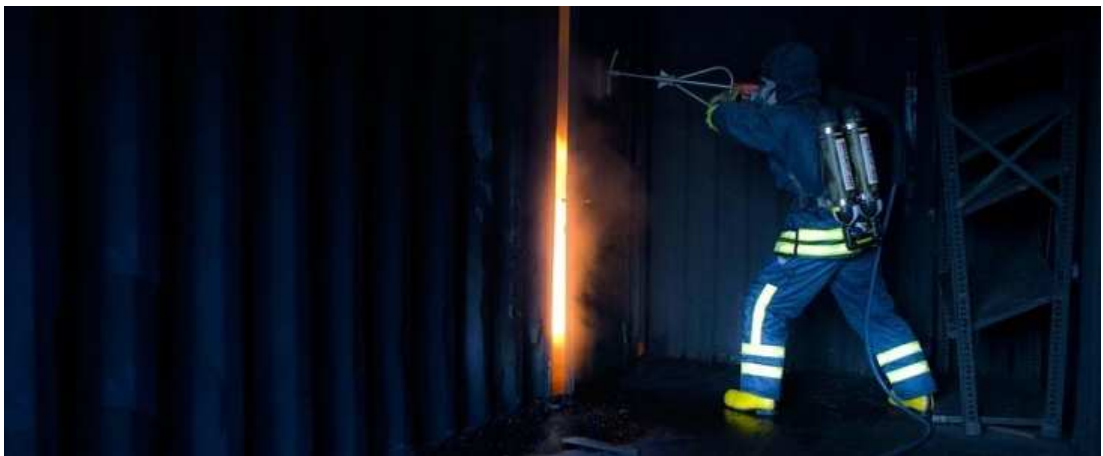
14. számú kép, Tűzoltás külső falsíkon keresztül, forrás: coldcutsystems.com
