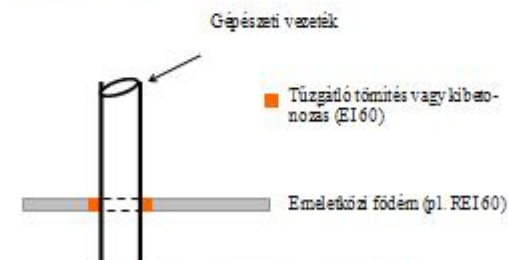
11. ábra Gépezeti vezeték földemárvzetése
