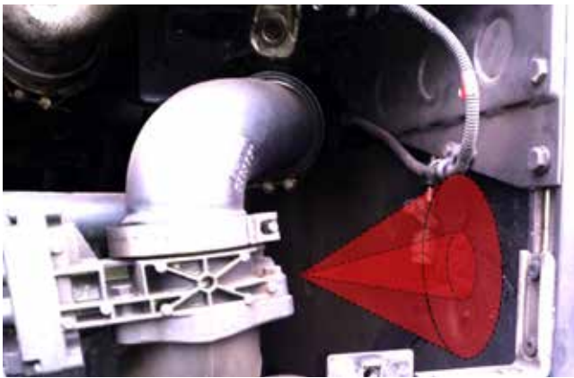
6. ÁBRA: A GYULLADÁSI HELY A REFERENCIAJÁRMŰBEN
