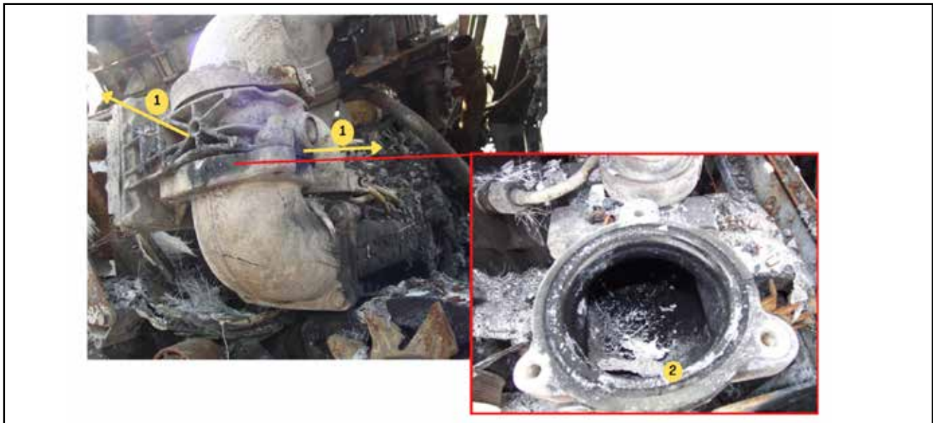
5. ÁBRA: KOROMKICSAPÓDÁS A KIFÚJÁS HELYÉN
