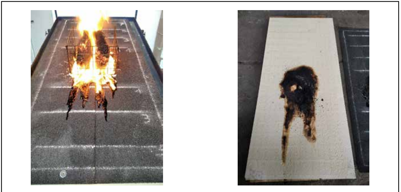
BALRA: HOSSZ- ÉS KERESZTIRÁNYÚ TŰZTERJEDÉS A BITUMENES VÍZSZIGETELÉSEN JOBBRA: TŰZTERJEDÉS A HŐSZIGETELŐ ANYAGBAN
