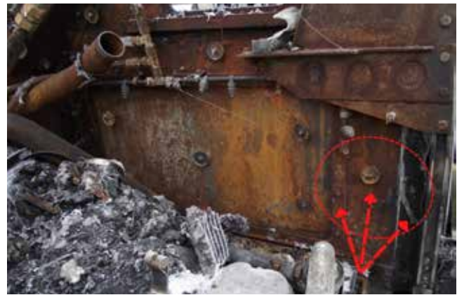
7. ÁBRA: A GYULLADÁSI KÖRNYEZET (ERŐS KIEGÉS NYOMA A TŰZFALON)
