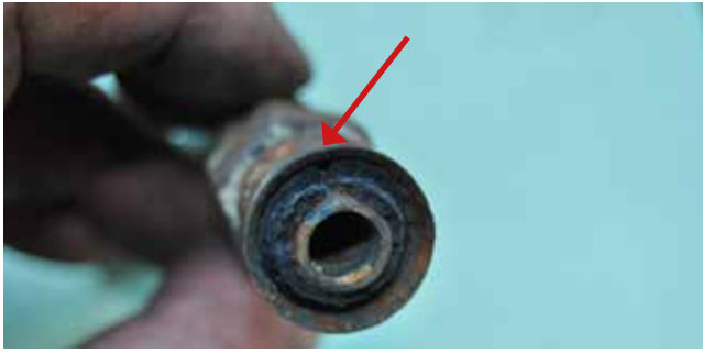
13. HOSSZANTI REPEDÉS A GUMITÖMLŐ PRÉSELÉSÉBEN
