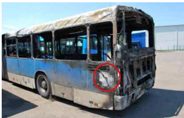
1. ERŐS ÁTÉGÉS A KÜLSŐ BURKOLATON
