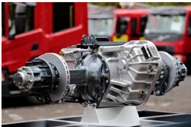
ELEKTROMOS HAJTOTT TENGYEL AZ ALLISONTÓL
