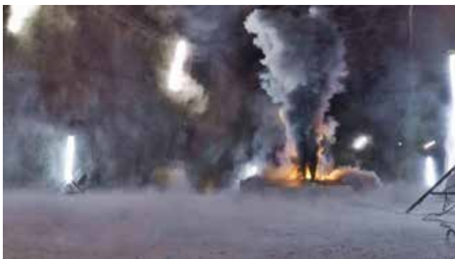
ELEKTROMOS AUTÓ AKKUMULÁTOR – SOK, MÉRGEZŐ FÉMOXIDOKAT TARTALMAZÓ KOROM (AMSTEIN + WALTHERT PROGRESS AG / EMPA)
