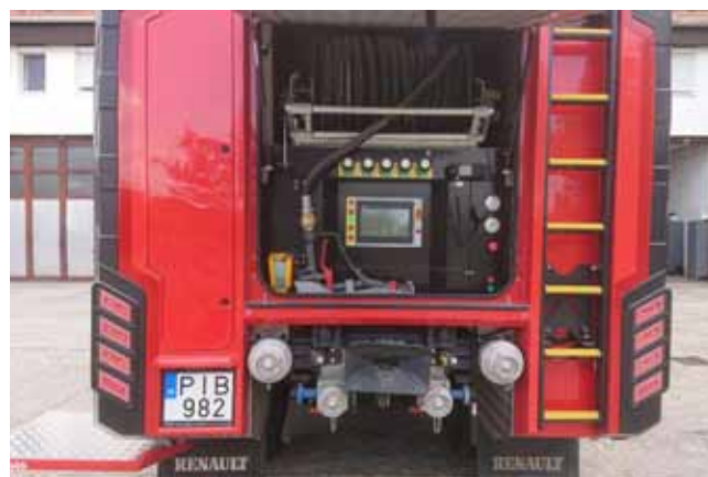
AZ AQUAREX S10 VÍZSZÁLLÍTÓ GÉPJÁRMŰ SZIVATTYÚTERE
