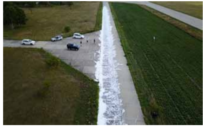
EGY FÖLDI TESZT EREDMÉNYE: A TÉGLALAP ALAKÚ SZÓRÁSKÉP JÓL MEGFIGYELHETŐ
