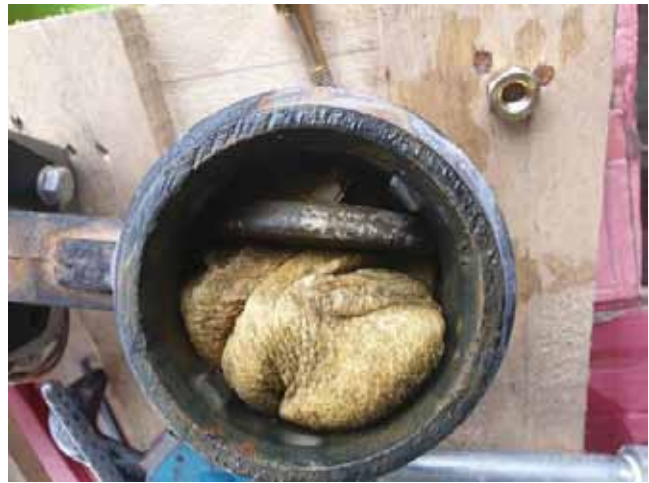
A TŰZIVIZET IS KELL SZŰRNI, DE NEM ENNYIRE – TELJES KRESZTMETSZETBEN EL VAN TÖMÖDVE A SZELEP
