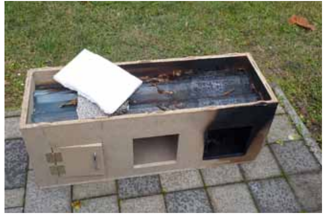
TELJESEN KIÉGETT A HŐSZIGETELŐ ANYAG
