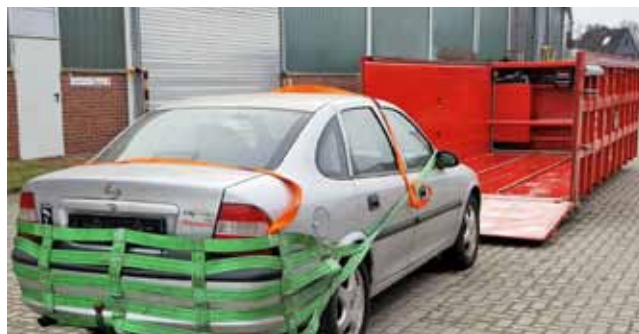
SZEMÉLYGÉPJÁRMŰ BEVONTATÁSA A KONTÉNER SAJÁT CSÖRLŐJÉVEL [1]
