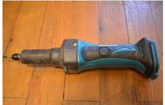
EGYENESCSISZOLÓ A SPECIÁLIS MARÁSHOZ HASZNÁLHATÓ FÚRÓSZÁLLAL
