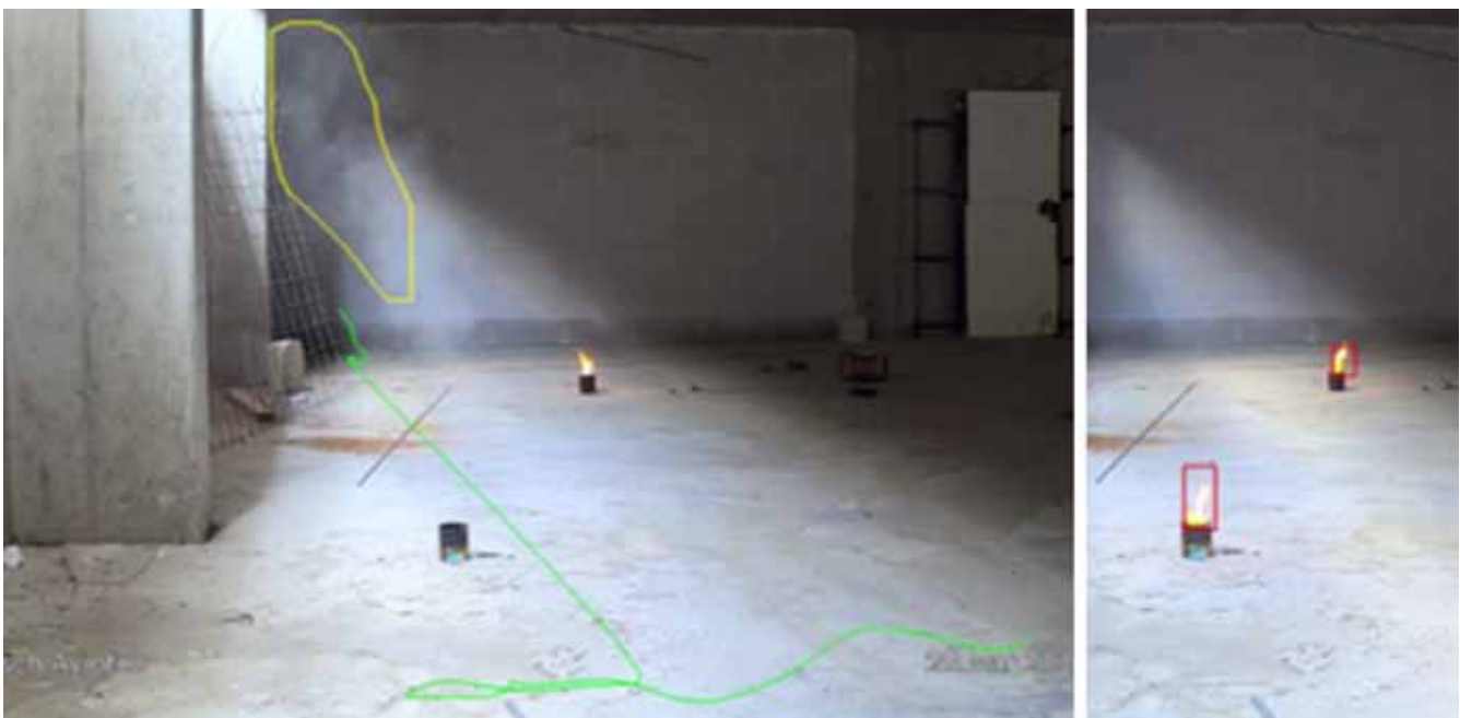
DETEKTÁLT FÜST- ÉS DETEKTÁLT LÁNG MASZKOLVA
