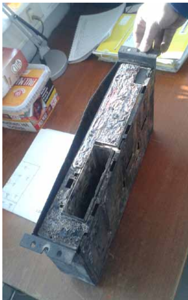
A TŰZZEL ÉRINTETT IRODÁBA TELEPÍTETT VIDÉO RENDSZER MEGÉGETT KÉPRÖGZÍTŐ EGYSÉGE
