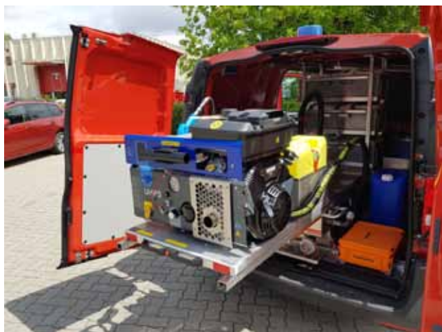
A BEÉPÍTETT UHPS OLTÓBERENDEZÉS
