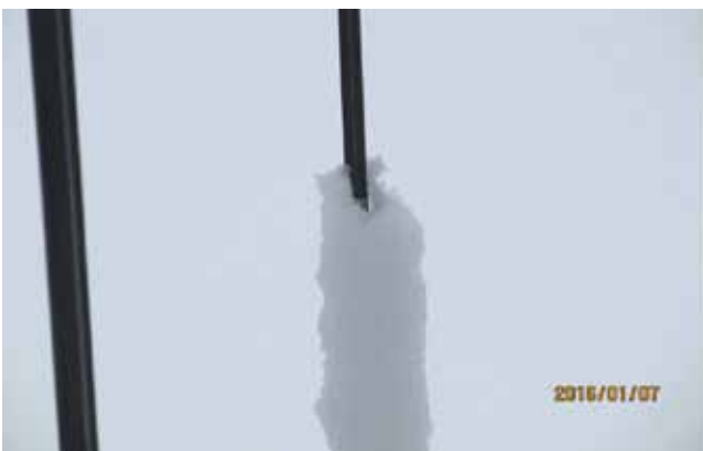
6. ÁBRA: A VEZETÉKEKRE TAPADÓ JÉG ÉS HÓ
