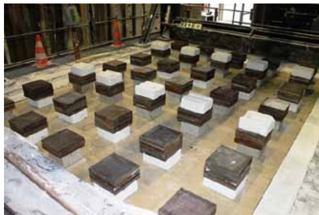
TETŐPANEL MODELLEN AZ (MSZ) EN1365-2 VIZSGÁLATI SZABVÁNY [11] SZERINT VÉGREHAJTOTT LABORATÓRIUMI VIZSGÁLAT
