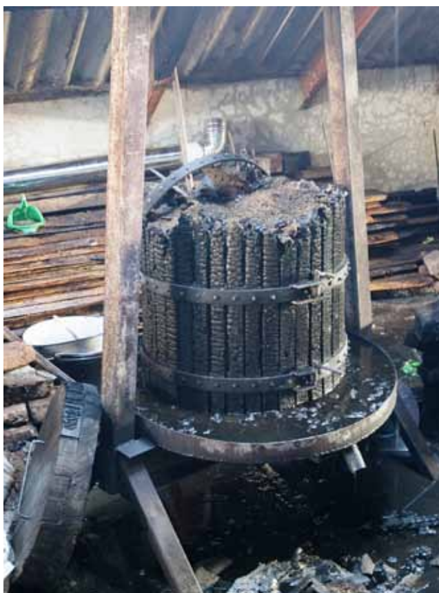
A PRÉS KÜLSEJE ÉS A FELSŐ RÉSZE JÓL MUTATJA AZ ÉGÉS TERJEDÉS IRÁNYÁT
