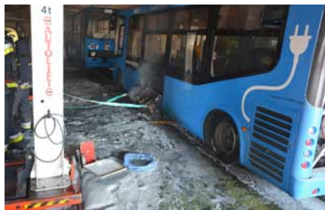
KIVONTATJÁK AZ AKKUMULÁTORT A BUSZBÓL
