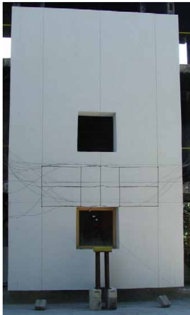
I. ÁBRA: HOMLOKZATI HŐSZIGETELŐ RENDSZER MSZ 14800-6:2009 szerinti vizsgálatra előkészített mintája az ÉMI Nonprofit Kft. Tűzvédelmi vizsgáló egységének szentendrei laboratóriumában
