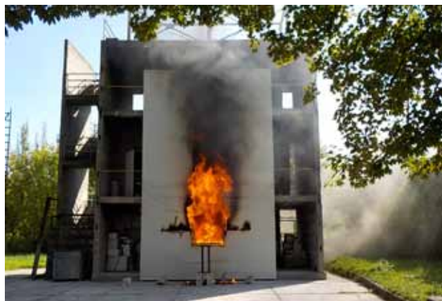
A PANEL ILLESZTÉSEKNÉL KIS LÁNGOKKAL ÉGETT A HŐSZIGETELŐ ANYAG, MAJD KIALUDT
