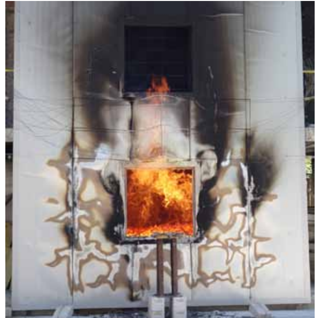
5. ÁBRA: AZ ÁLLÓ FALPANELES SZENDVICSPANEL HOMLOKZAT KÖZVETLENÜL A VIZSGÁLATOT KÖVETŐEN
