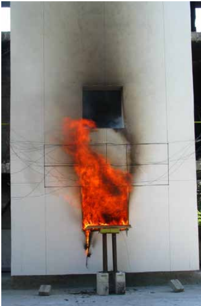
2. ÁBRA: HOMLOKZATI HŐSZIGETELŐ RENDSZER MSZ 14800-6:2009 szerinti vizsgálata
