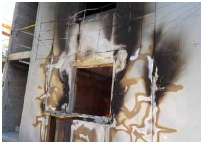
A TŰZHATÁS KÉPE KIRAJZOLÓDOTT A PANELEKEN
