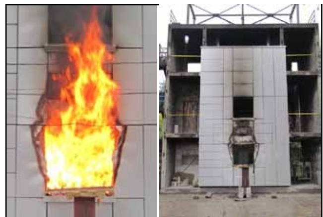
KOMPOZIT BURKOLAT (a2-s1,d0) VIZSGÁLATA – MEGFELELT
