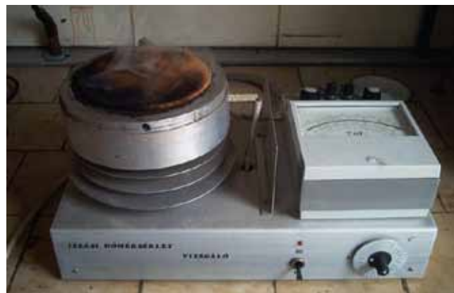
A LEÜLEPEDETT POR IZZÁSI HŐMÉRSÉKLETÉT MÉRŐ (MSZ 21885-18)
