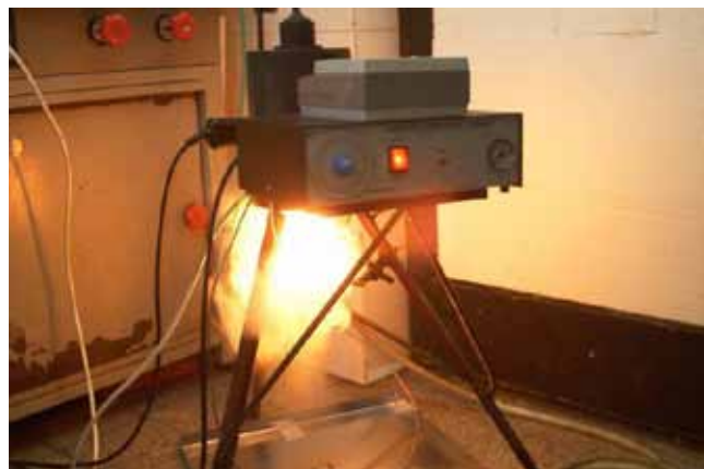
SZÁLLÓ PORFELÜLET, GODBERT-GREENWALD-FÉLE GYULLADÁSI HŐMÉRSÉKLET MÉRŐ
