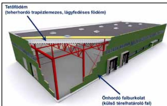
3B ÁBRA: CSARNOKSZERKEZETEK MÁSIK TÍPIKUS FELÉPÍTÉSE: LAPOSTETŐS, TEHERHORDÓ FÖDÉMLEMEZES
