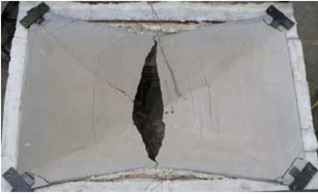
MAGASABB HŐMÉRSEKLETEN BEKÖVETKEZŐ TÖNKRE- MENETELI MÓD A TESZTFÖDÉMEKEN
