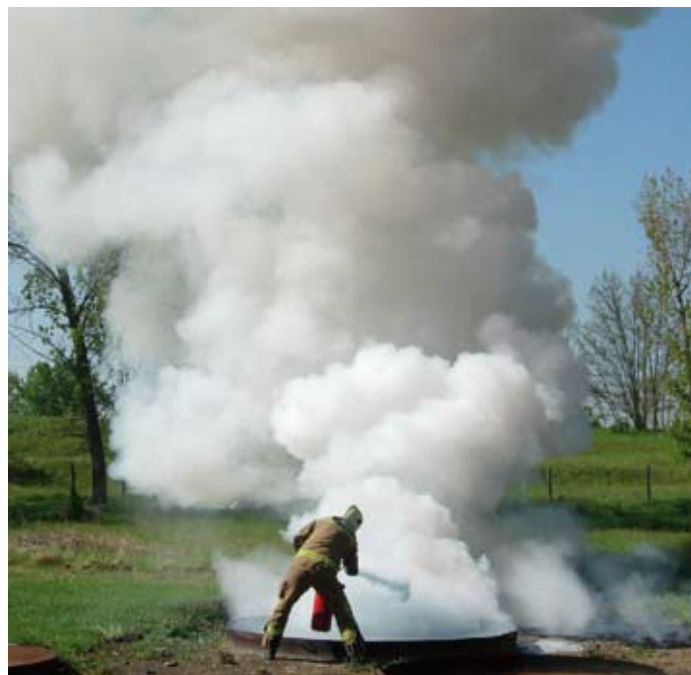
A B típusú modelltűzek 233B méretű maximuma a 6 kg-os porraloltóval
