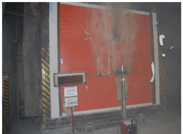
Falpanel tűzvédelmi tesztje (FIRES)
