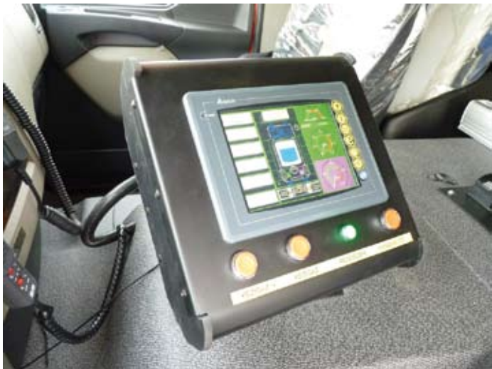
Kezelőpanel a járműfülkében
