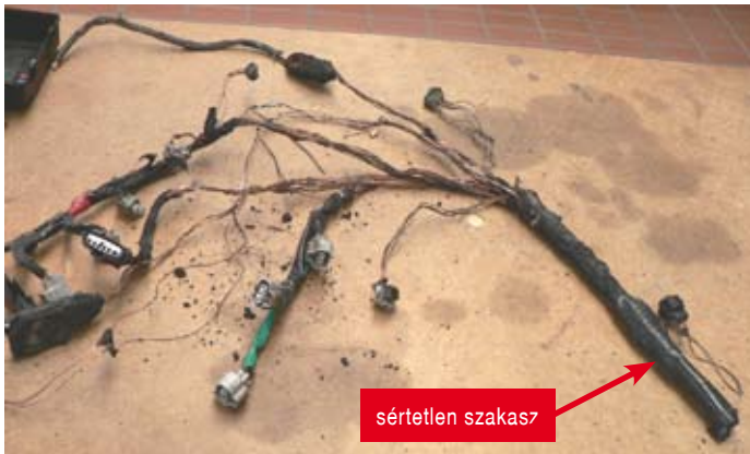
A vizsgálatra kivett kábelköteg
