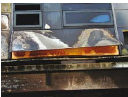
A panel szétvágása után a belső szigetelő mag lángoknak kitett oldalán mindössze enyhe szenesedés látható.
