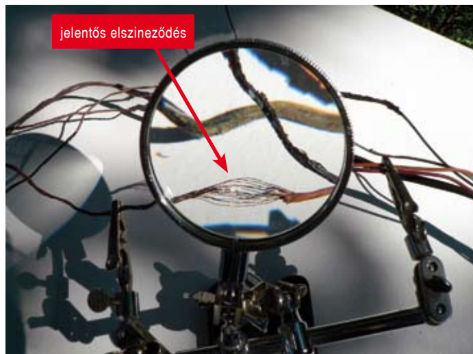
A hősokk képe egy szakaszon
