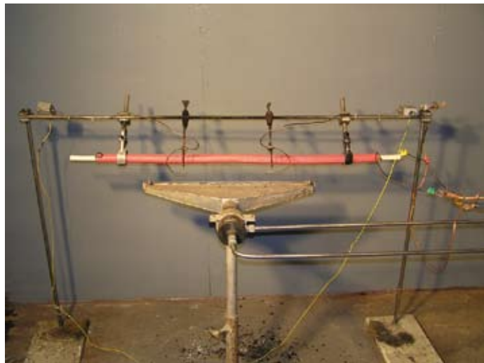
A rugalmas szigetelő réteg védi a vezetőt, amely hő hatására elég
