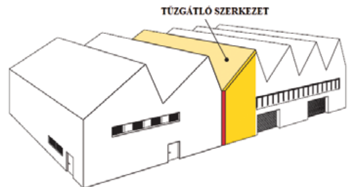
35. ábra. Shedtető tűzgátlása II.
