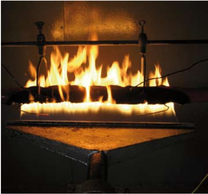
Kábelégetés tűzállósági teszt során
