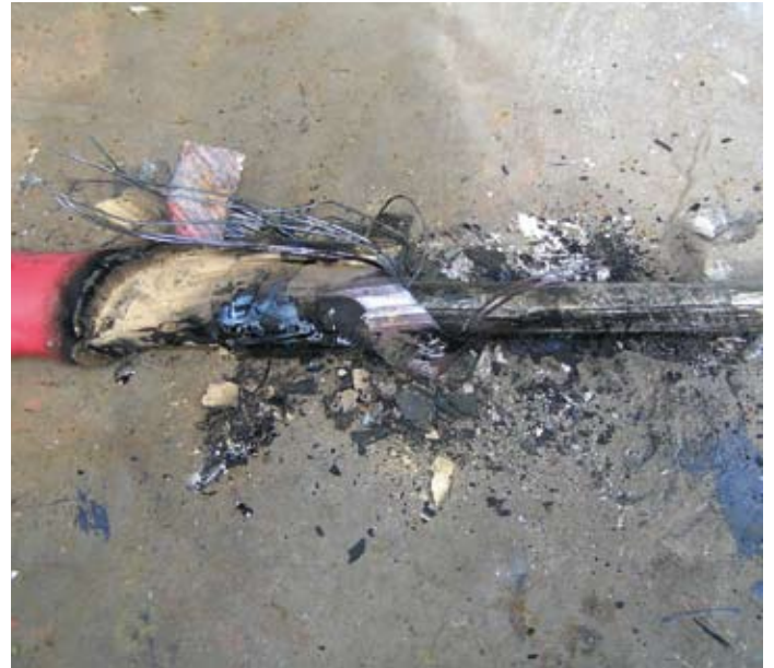
Kiégett kábel égetés után. Látható az épen maradt belső ér és az ép közvetlen érszigetelés a kép jobb szélén
