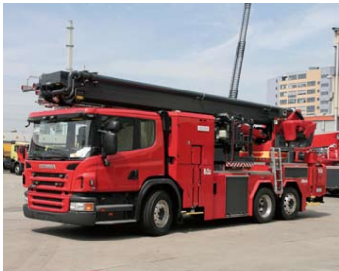
Metz B32 emelőkosár Scania LowEntry alvázon
