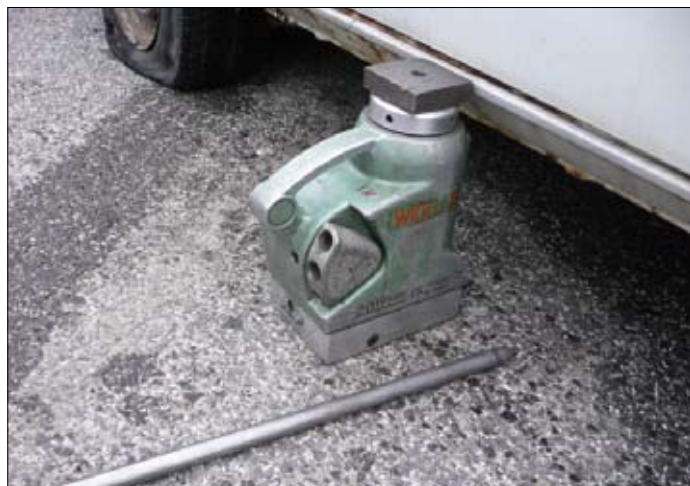
3. kép. Az emelő még felfújott kerekek mellett sem férne alá
