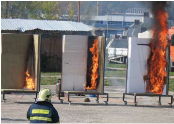
Tűzkísérlet: lehet tippelni melyik hőszigetelő ég
