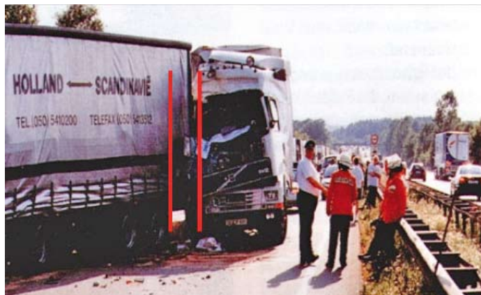
Átfedéses baleset gyűrődési jellemzői
