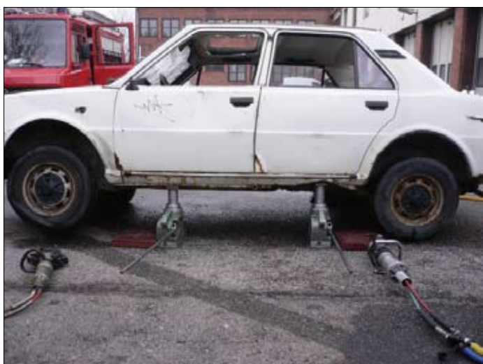
9. kép. A sérült helyzete miatt emelhetünk egy oldalon is
