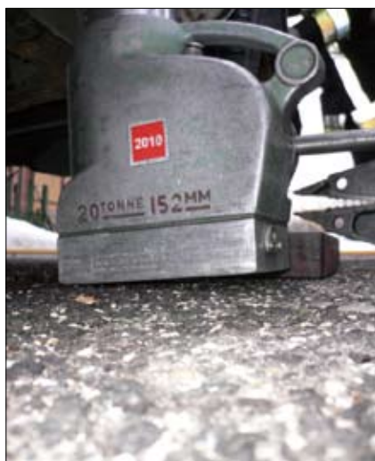
8. kép. Pontatlan telepítésnél még az emelő is megbillenhet
