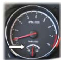
2. ábra. Töltés jelzés analóg műszeren
