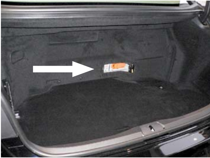
7. ábra. Limuzinok megszakítója a csomagterben
