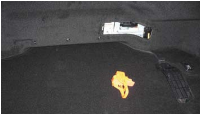
8. ábra. Az áramtalanítás megtörtént
