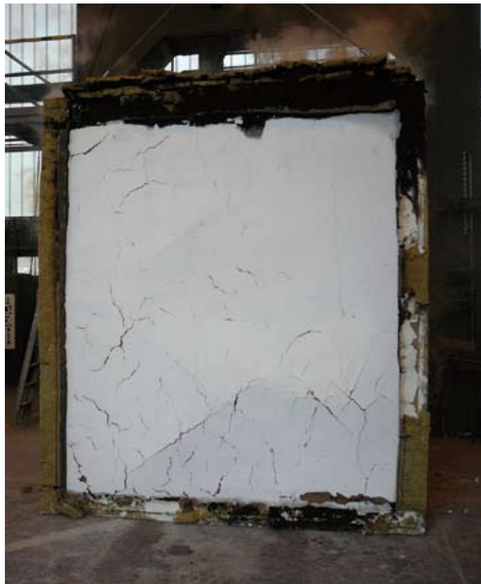
Szalmabála fal tűztérben lévő oldala a vizsgálat után
