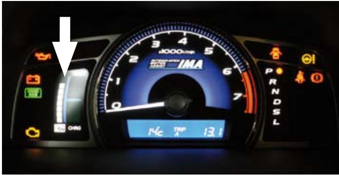
1. ábra. Töltés jelzés megvilágított műszerfalán
