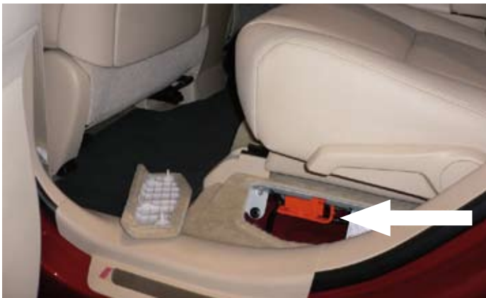
9. ábra. Terepjárók áramtalanítási lehetősége
