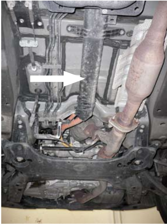
12. ábra. Alváz alatt futó H kábel
