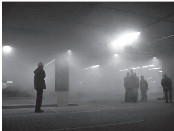
Füstkísérlettel tesztelték a Jet ventilátoros füstelvezetést
