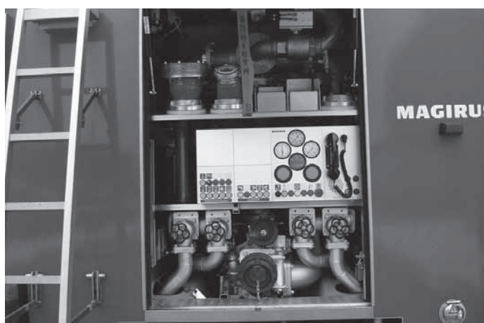
Jól áttekinthető szivattyútér
