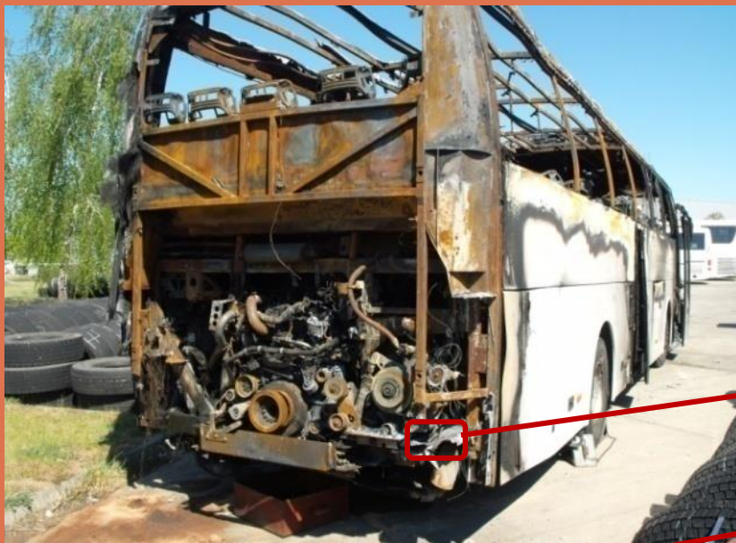
A GENERÁTORRA CSATLAKOZÓ VEZETÉKEK
