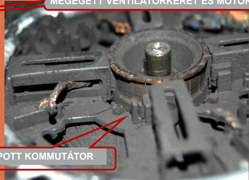
MEGÉGETT VENTILÁTORKERET ÉS MOTOR
