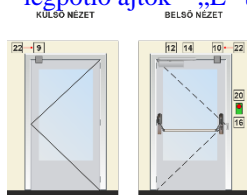
G21. ábra: Egyszárnyú, elektromos zárással rendelkező homlokzati ajtók / tüzgátó vagy légpótló ajtók – „E” típus
