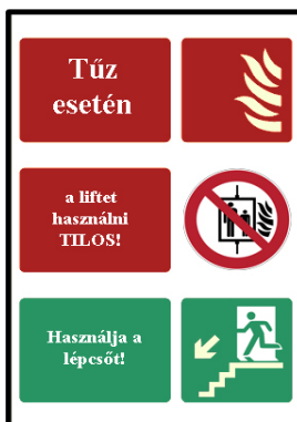
11.14. ábra: Nem biztonsági felvonók tüzeseti használati veszélyére figyelmeztető tábla
