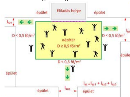
7. ábra: A kezdeti szabad menekülési szélesség zöld vonallal, a menekülésre figyelembe vett útvonalak legkisebb szabad szélességeinek összege piros méretnyilakkal szemléltetve (a második számítási metódushoz kapcsolódó ábra)
