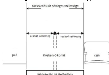
C3. ábra: 1Nézőtéri, előadótermi és hasonló jellegű terek közlekedő útvonalába épített korlát, valamint az útvonalat határoló pad, szék figyelembevétele a szabad szélesség megállapításánál
