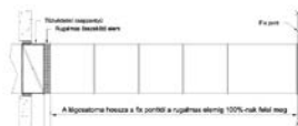
2D5.1.3. ábra. Tűzcappantyú és egy fix ponttal beépített egyes acél szellőző légszatórna kapcsolódási rugalmas összekötő elem alkalmazásával
