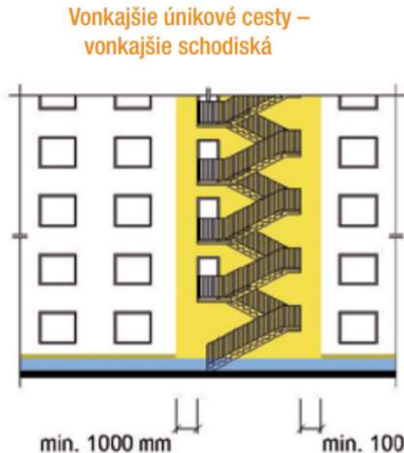
Obr. 24 Zateplenie obvodovej steny v oblasti vonkajších únikových a zásahových ciest
