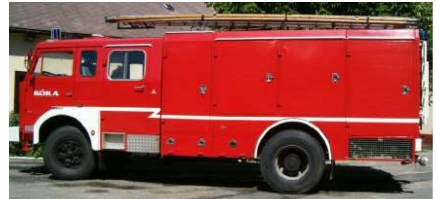
Csepel 750 alváz - Rába motor - Jelz fülke - Labor MIM felépítmény Rosenbauer szivattyú
