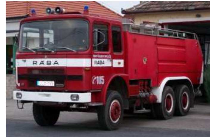
Rába U26.230 alváz - Labor MIM felépítmény – Rosenbauer szivattyú
