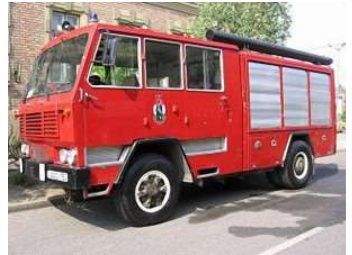
Csepel 707.30 alváz - Labor MIM felépítmény - Digép szivattyú - Elzett porrendszer
