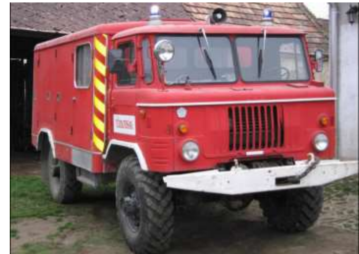
GAZ-66 alváz - Labor MIM felépítmény – Rosenbauer szivattyú
