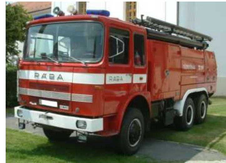
Rába U 26.230 alváz - Labor MIM felépítmény – Rosenbauer szivattyú
