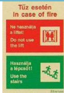
15. ábra: Példa tűzhatástól nem védett felvonók tüzeseti használati veszélyére figyelmeztető kétnyelvű táblára
