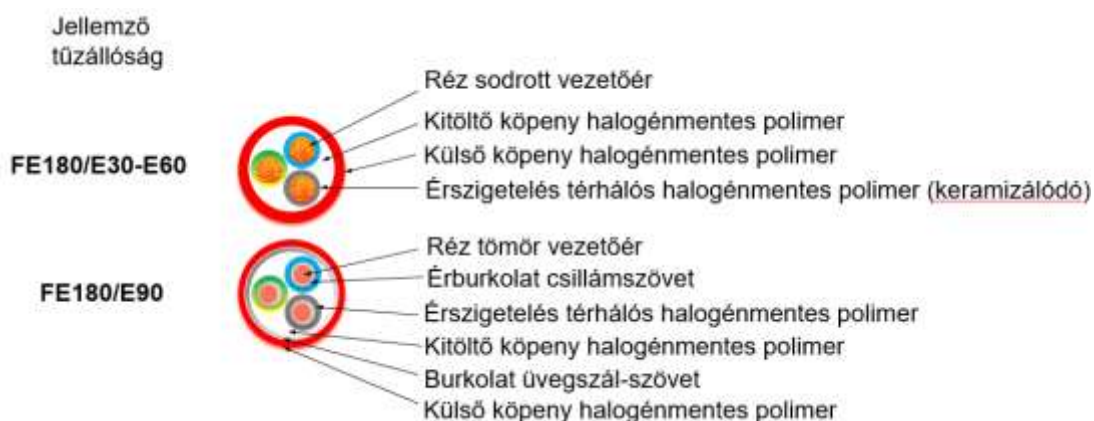
1. ábra: Tűzálló kábeleknél alkalmazott szerkezeti kialakítás 5
