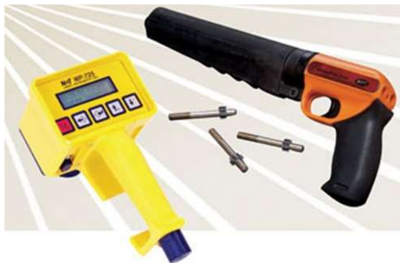
8. ábra: Windsor próbához használt készülék
