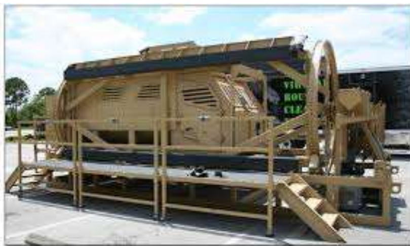
2. számú ábra: A Magyar Honvédség által is használt ROLLOVER borulást szimuláló eszköz (forrás: internet TEAMORLANDO honlapja, Letöltve 2021. szeptember 08.)
