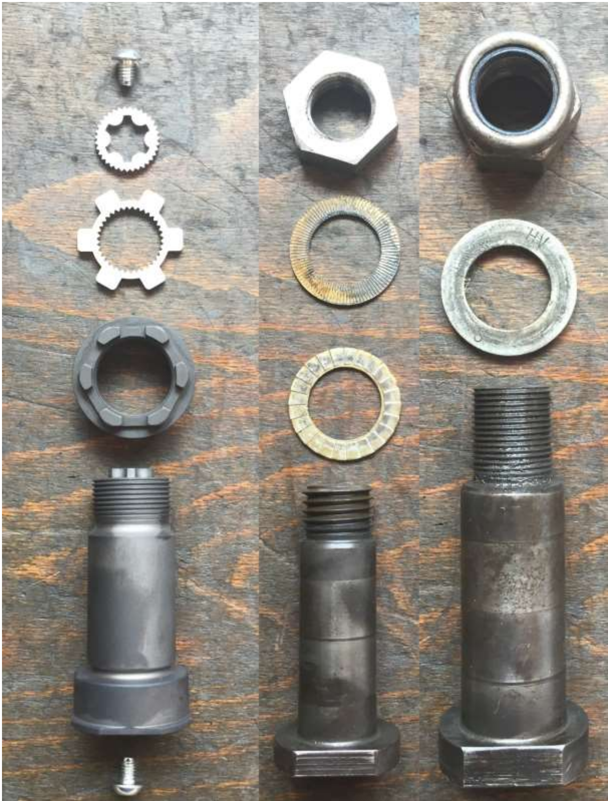
2. ábra Központi függőcsapszegek: i-Bolt; Nord Lock rendszerű; és önzáró anyás
