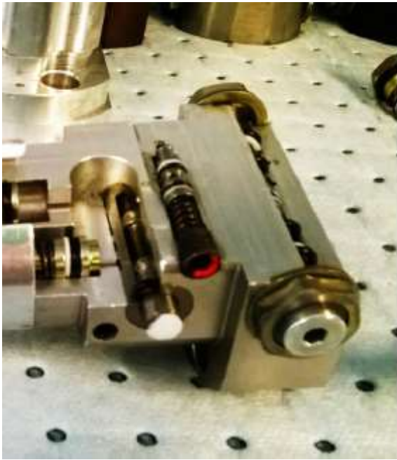
3. ábra Vezérlő markolat az útváltó szeleppel (balra) és annak tolattyúja (jobbra)
