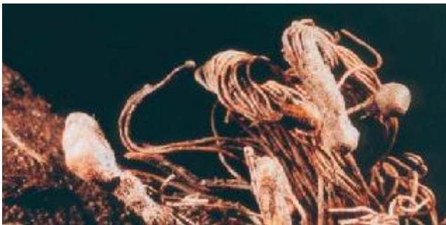
Rézvezetéken keletkezett makroszkópikus göbök (zárlati ömlenyek)
